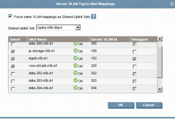
VLAN 100 – IP-Storage VLAN 101 - Vmotion VLAN 182 – Mgmt VLAN 200 – Ctrl-Pkt
